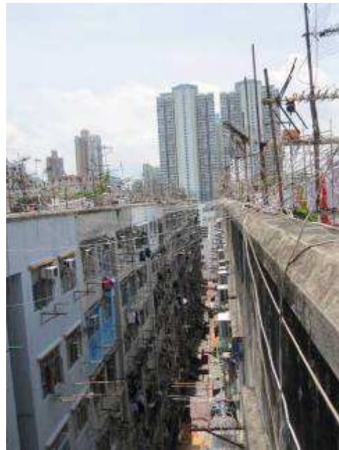
原本相連的天台分被大閘分隔開，有天線沿大廈外牆駁進屋內，更有部分天線橫跨兼善里，駁到對面大廈。
